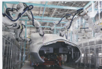
▲車両先端部研ぎロボット
