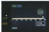
▲N700系車両による最高速度330km/hの実証運転
